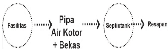
Gambar 35 Utilitas Air Kotor Sumber: Penulis
