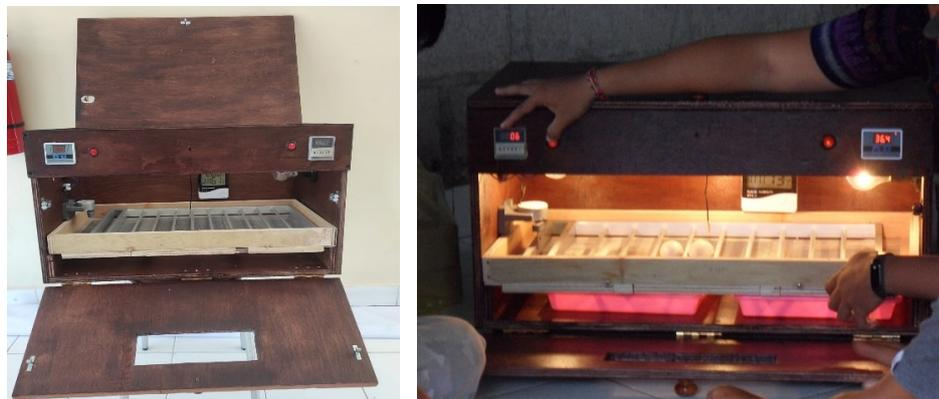
Gambar 6. Alat Penetas Telur Full Otomatis
