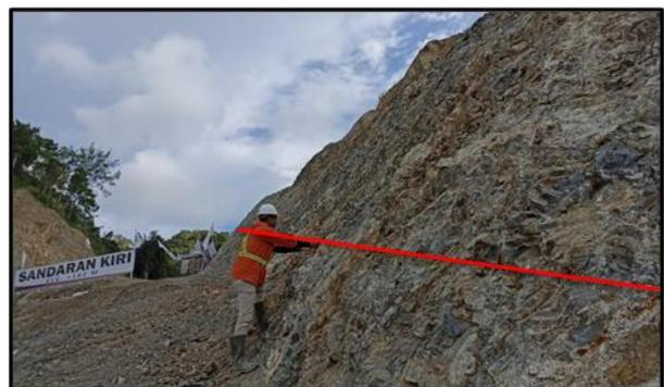
**Gambar 2.** Pengukuran data diskontinuitas segmen E-F pada sandaran kiri lereng bendungan
