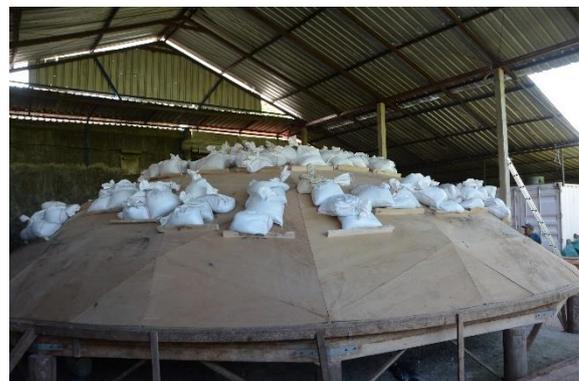
**Gambar 3.** Uji Beban Tahap Kedua dengan Memberikan Beban Merata pada Permukaan Kubah
