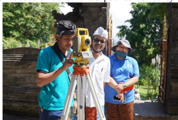
Gambar 5 Pengukuran topografi dengan Total Station
